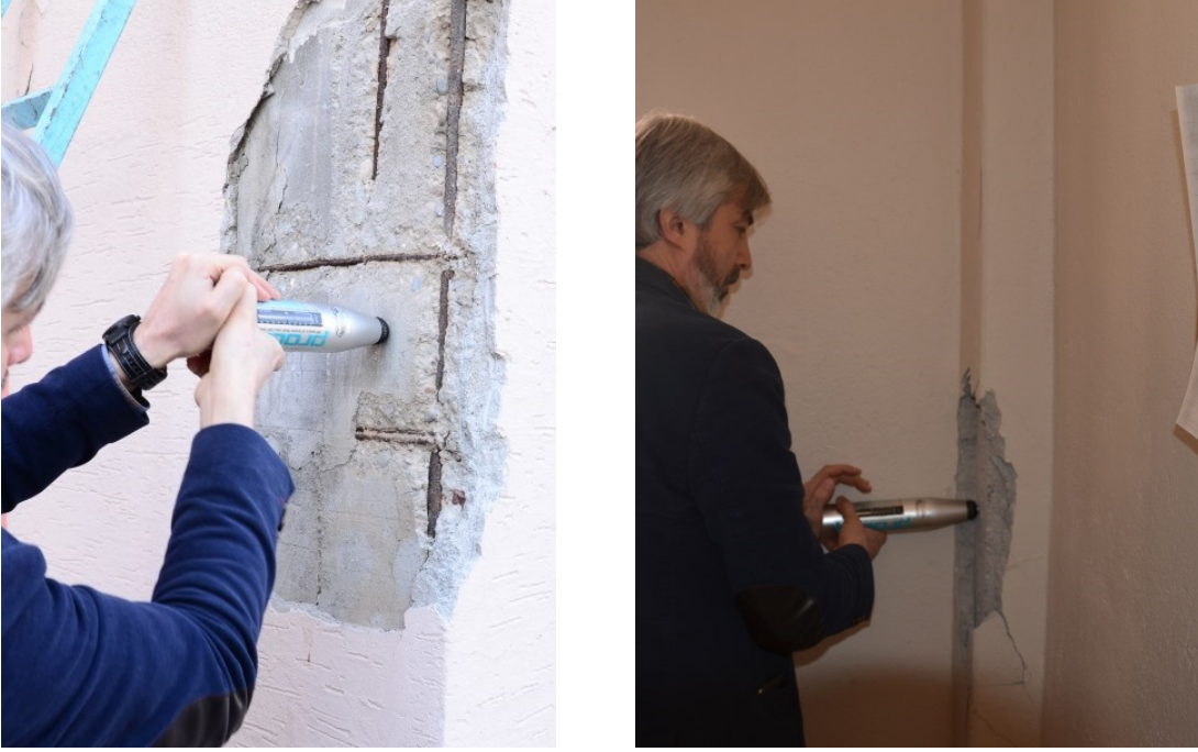
Şekil 16. Betonarme kolonlarda schmidt çekici okumaları
