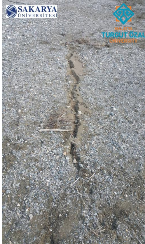
Foto 3. Pütürge civarında Şiro (Mollahasan) deresi yatağı boyunca gözlenen kum fişkırması şeklindeki zemin sıvılaşması. Fotoğraftaki bakış istikameti KD'ya doğrudur.
